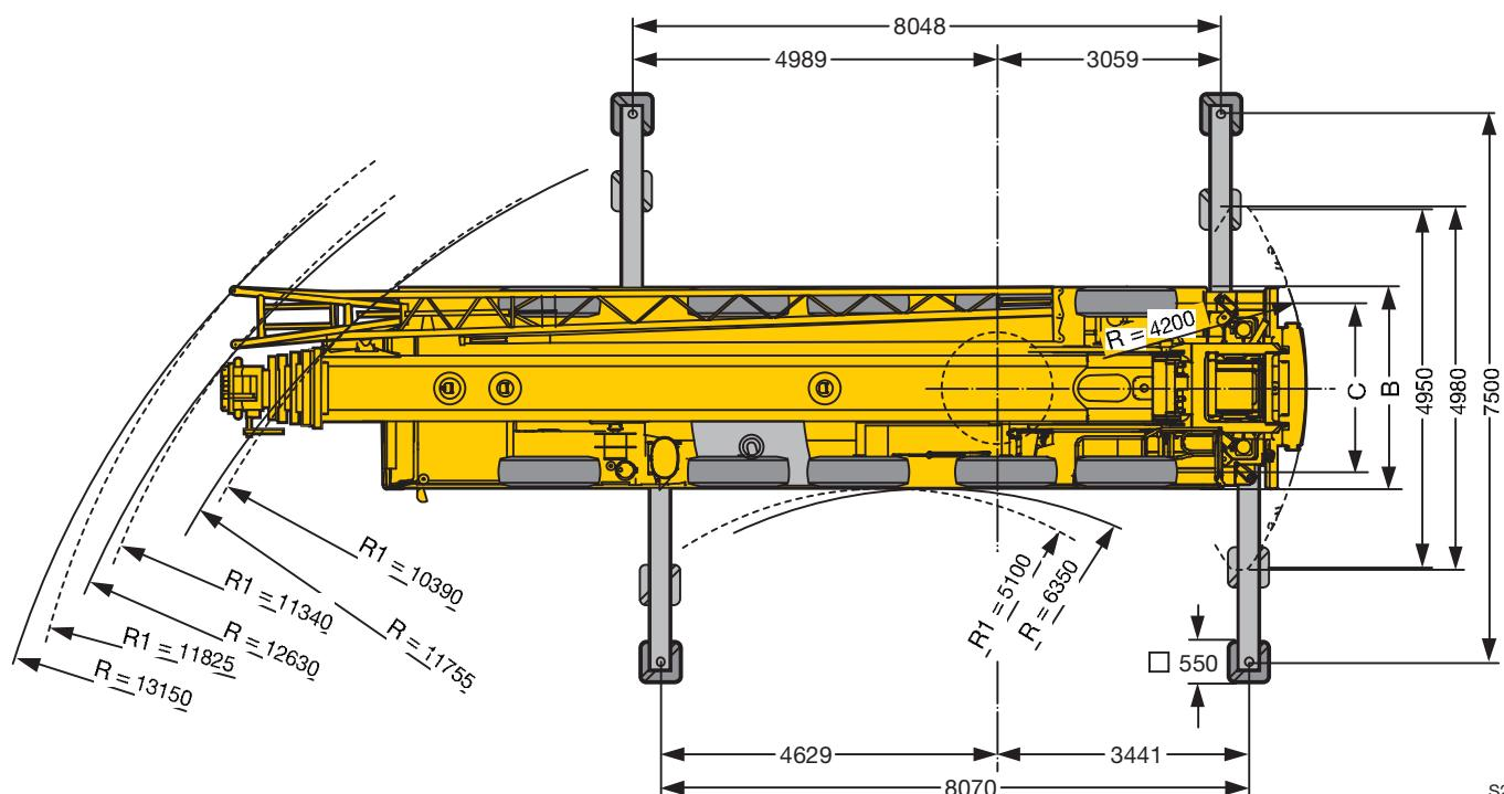
$R_i$  = Allradlenkung · All-wheel steering · Direction toutes roues · Tutti gli assi sterzanti · Dirección en todos los ejes · Поворот всеми колесами
