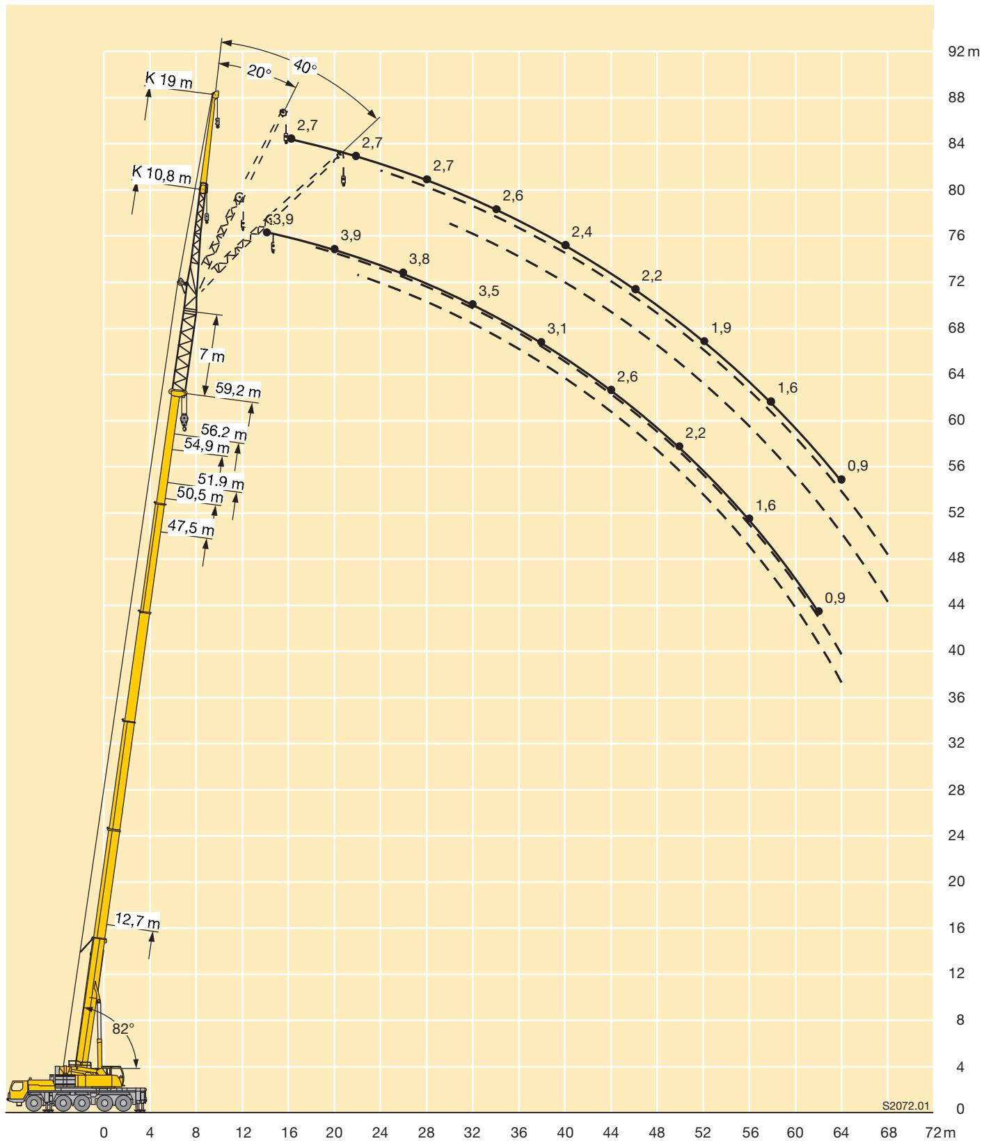
**Traglasten an der mechanisch oder hydraulisch verstellbaren Klappspitze mit verlängertem Teleskopausleger**
