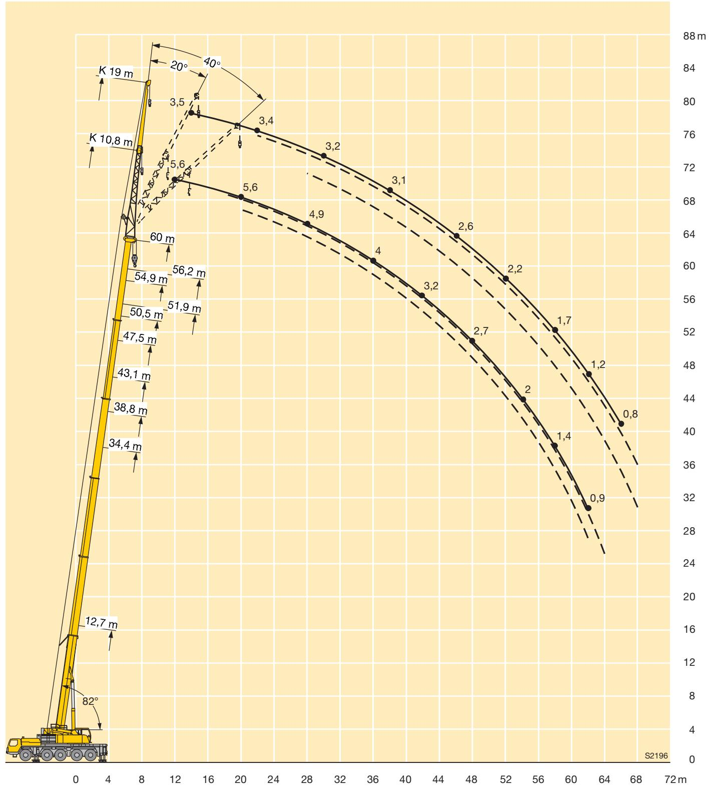
**Traglasten an der mechanisch oder hydraulisch verstellbaren Klappspitze mit verlängertem Teleskopausleger**
